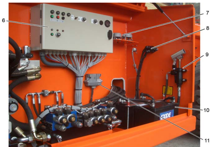
Soupapes et générateur
