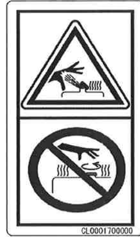
(20) Voorzorgsmaatregelen om het risico op brandwonden te beperken (CL000170000) [2 plaatsen]
