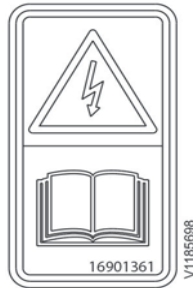
5 WAARSCHUWING! Alvorens de startkabels aan te sluiten eerst het instructieboek doornemen (Artikelnummer in de VS: 13935004)
